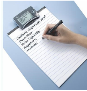
الشكل ٥: يتكون المدون المتنقل من قلم و ورق إلكتروني لتخزين نسخة إلكترونية من المحتوى المكتوب مباشرة
